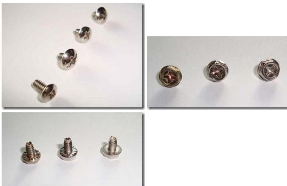
На фотографиях выше приведены самые распространенные винты. Они используются для крепления **AGP, PCI, PCI Express** и других **интерфейсных плат** во внутренние слота персональных компьютеров и серверов. Также эти болты используются для крепления боковых стенок многих корпусов системных блоков, а также для крепления блока питания. Ну и самое главное, именно эти винты используются для крепления **жестких дисков**, т.е. **HDD** или **винчестеров**, как кому нравится.
