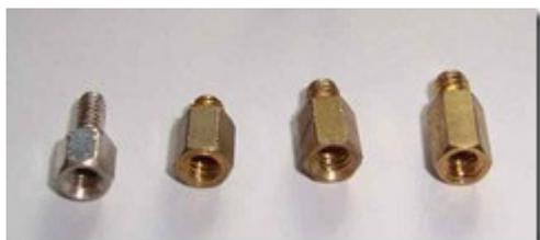
Данный вид болтов используется для ввинчивания во внутреннюю плоскость **корпуса системного блока**, для последующего прикрепления **материнской платы**. Никелированный и омеднённый болты отличаются диаметром и шагом резьбы. Болты из медного сплава отличаются только длиной.
