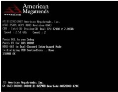
Во время **начальной загрузки компьютера** при помощи программ, записанных в BIOS происходит предварительная проверка оборудования. В случае сбоя во время **проверки BIOS** может выдать информацию, позволяющую выявить причину сбоя. Такие сообщения, в первую очередь, используются для определения потенциально неисправных элементов (комплектующих компьютера) для их дальнейшего ремонта или замены.
