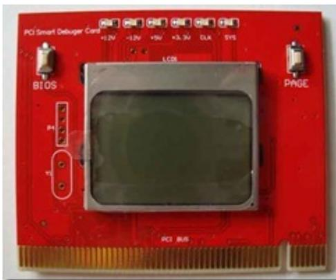
По последнему выведенному коду можно определить, в каком из компонентов имеется неисправность. Данные коды зависят от производителя **BIOS материнской платы**. В случае отсутствия ошибок и нормального прохождения теста POST выдаёт на свой индикатор не меняющееся на протяжении работы компьютера значение, зависящее от версии BIOS, например, на большинстве плат по окончании инициализации выдаётся
